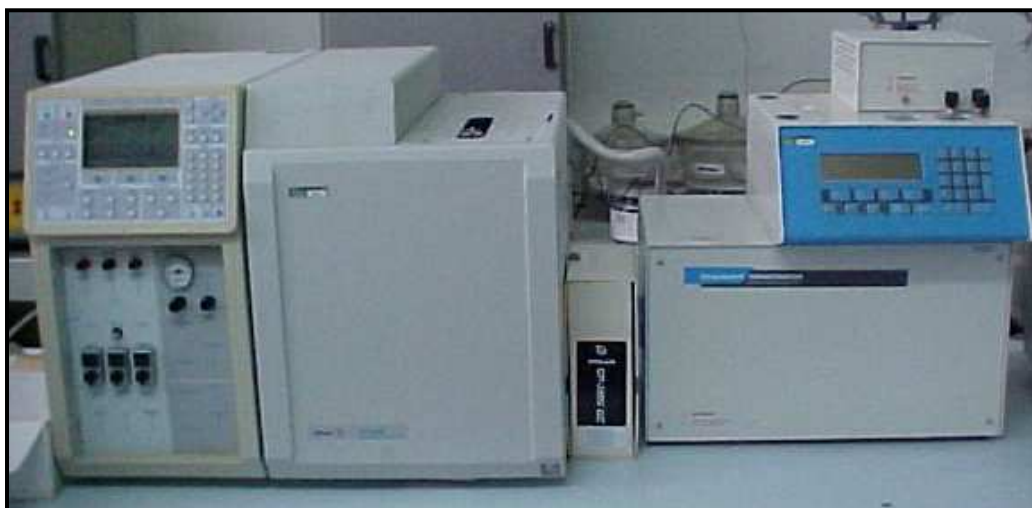
Figura 3 – Sistema de análise Cromatografia Headspace
