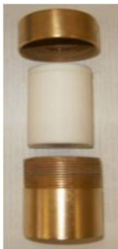
Figura 7. Autoclave usado na síntese da zeólita
