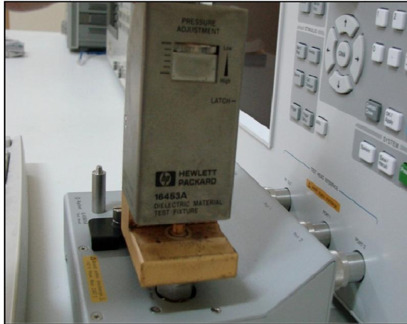
Figura 4.2.5.1 – Dispositivo para medida dielétrica
